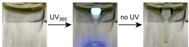
図5. network-PDMS HABI への UV 365 照射によって流動性が変化した様子の写真
