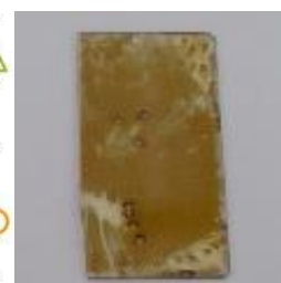
図10. 液体Siから得たSi薄膜。ホール測定からp型であることを確認。
