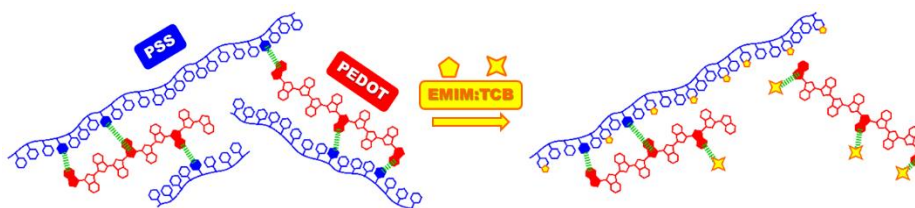
図4：IL添加によりPSSの一部がTCBに置換されたPEDOT
