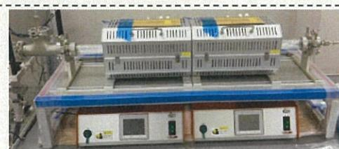
図4  $\text{g-C}_3\text{N}_4$  作製用のCVD装置。
