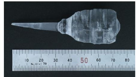
図 2. Cz 法作製 CSMS30 結晶
