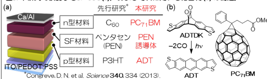
図3. 本研究で検討するSF-OSC (a), およびそれに用いる化合物 (b) の構造。
