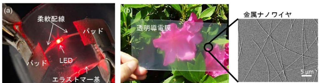
図 2 : (a) Ag ナノワイヤを用いて高輝度 LED を発光させている様子。ナノワイヤの長さや太さを最適化することで 1000 \text{ S/cm} を超える高い導電性を得ることができた。(b) 可視光領域における透明性を示す写真と電子顕微鏡による透明電極の拡大図。Ag ナノワイヤが見える。
