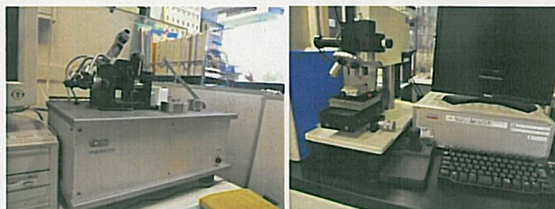
図 3.測定装置。いずれも石川県工業試験場の装置を有償で借りて測定を行った。(左) 摩擦摩耗評価装置 (右) スクラッチ試験機
