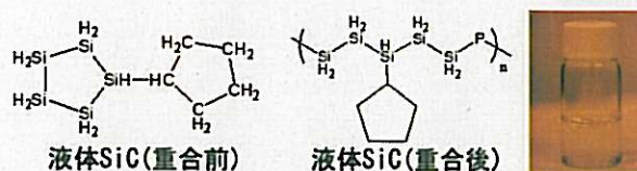
図 1. 重合前後の液体 SiC の化学構造と外観写真。炭素ユニットは異なる官能基に変更可能。ここでは一例としてシクロペンタンを導入している
