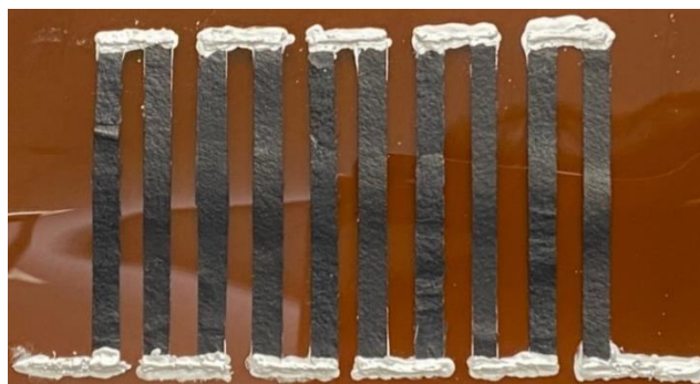
図 3 5 p-n カップルモジュールのデジタル写真
