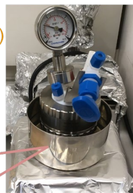
図3 強酸化反応を実現するオートクレーブ反応器の構築。
